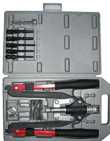
Заклепочник для анкеров гаек - до 10мм, заклепок - до 6,4мм
