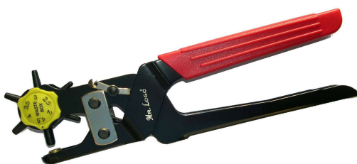
Просекатель отверстий в коже диаметром (2,5-4,5мм)
