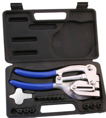
Просекатель для листовой стали (до 2мм при 42HRC) Размеры отверстий: 2,38; 3,18; 3,97; 4,76; 5,56; 6,35; 7,14мм
