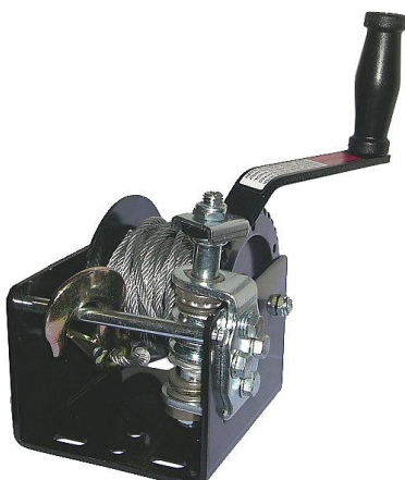
Лебедка стационарная червячная. Грузоподъемность - 900/450кг Длина троса - 10м, диаметр троса - 6мм
